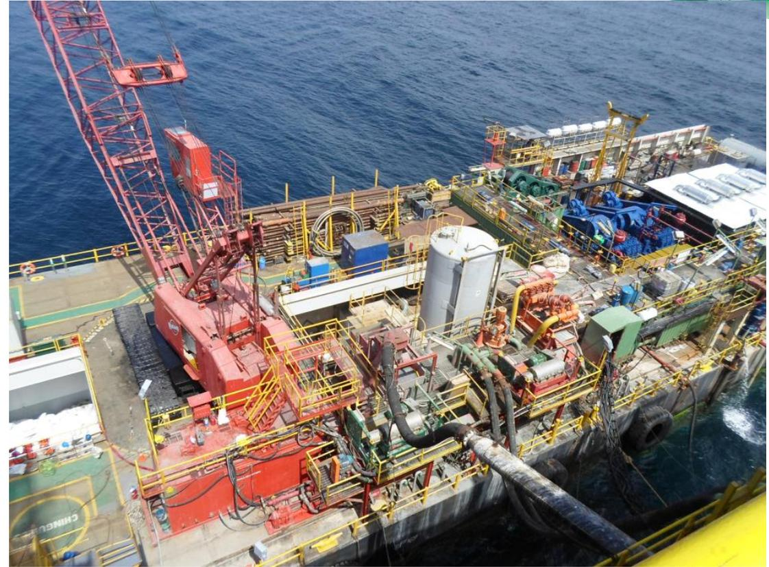
**Figura 16.** Cubierta principal de la barcaza del taladro PER28 con la maquinaria de apoyo para perforación.
