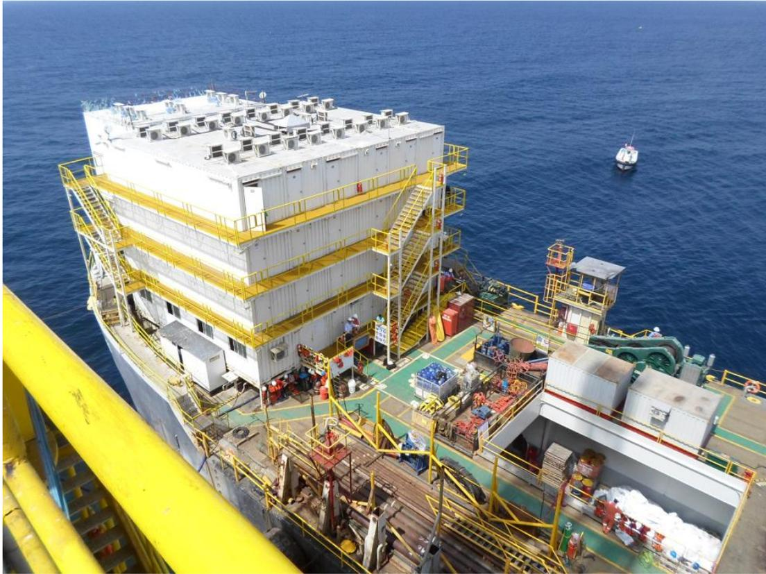
**Figura 15.** Cubierta principal de la barcaza del taladro PER28 con la maquinaria de apoyo para perforación y contenedores para alojamiento del personal.
